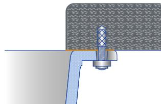
Für den Unterbau von Einbauspülen müssen spezielle Halteelemente verwendet werden.
